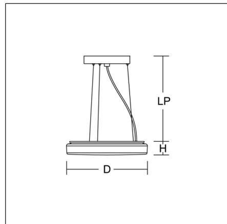
Dekorative runde LED Pendelleuchte. Armatur und Baldachin Metall pulverbeschichtet weiß. Baldachin Ø 205 mm, h 35 mm. Diffusor aus vergilbungsfreiem Kunststoff (PMMA) opal. Befestigung des Diffusors mit patentierter Verschlussmechanik (Druckverschluss). Homogene und weiche Ausleuchtung. Geeignet für Pendel. 3-Punkt Stahlseilabhängung stufenlos höhenverstellbar oder gewünschte Sonderlängen auf Anfrage.
