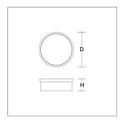
Luminaire apparent rond au design classique. Armature en matière synthétique. Diffuseur en matière synthétique (polyprophylène) opalin mat satiné. Fixation du diffuseur par système de ressorts. Convient à Montage des plafonniers, Flèche murale. IP 43 montage au plafond, IP 44 montage mural.
