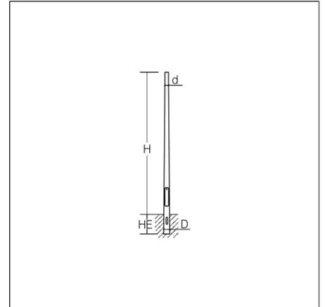
Pylône conique en acier. Galvanisé à chaud selon DIN EN ISO 1461. Trappe du mât affleurante, 85 x 400 mm, selon DIN 48778 avec verrouillage à 3 arêtes, autres fermetures sur demande. Arête de l'appareil avec deux écrous coulissants et une patte de mise à la terre. Orifice de câble 50 x 150 mm (bord inférieur de l'orifice de câble 500 mm sous terre)
