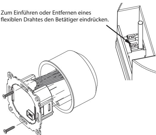
Die Drähte müssen so montiert werden, dass der Kunststoffstreifen als Isolation zur Befestigungsschraube wirkt.
