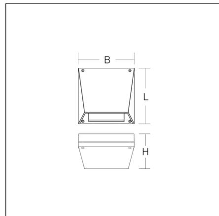
Applique pour éclairage des issues de secours. Corps en aluminium injecté traité époxy. Avec optiques à lentilles pour l'éclairage de surface. Appareillage intégré. Système de batterie autonome avec auto-test automatique.
