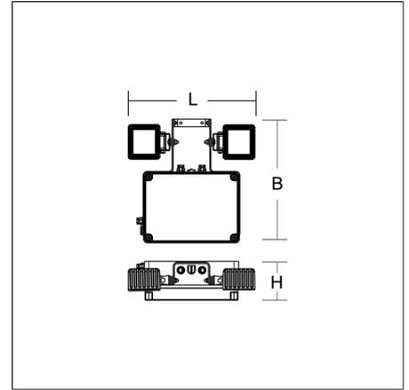
Sicherheits-Standscheinwerfer. Gehäuse Kunststoff, grau. Leuchtenköpfe in alle Richtungen schwenkbar. Mit Anschlussleitung 2,5 m inklusive Schukostecker.
