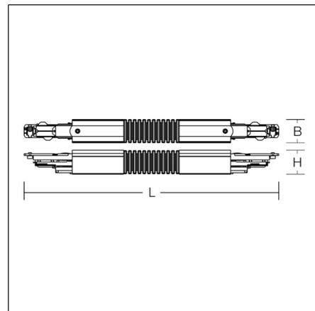
Acoplamiento flexible de material sintético. Línea adicional DALI de 2 polos integrada. Acoplamiento giratorio sin escalones,  $\pm 180^\circ$ , en sentido horizontal y vertical. Línea de alimentación 16A / 400V, línea piloto DALI 2x1A / 50V FELV AC.
