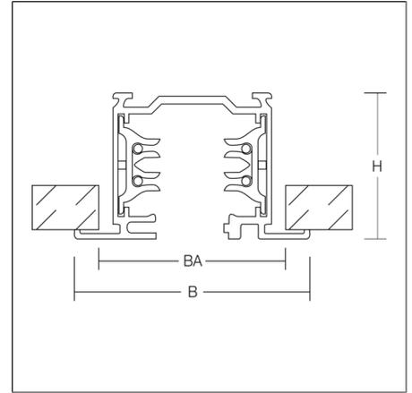
Aluminium-Strangpressprofil lackiert. Schienen beliebig ablängbar. Für den Handbereich zugelassen. Mit fünf Befestigungsbohrungen bei 100 mm, 990 mm, 1990 mm, 2990 mm und 3875 mm.
