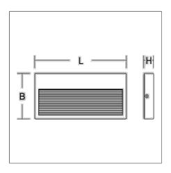
Luminaires apparents plats à LED pour l'éclairage en surface du mur, p. ex. sur des marches ou des couloirs. Corps en aluminium injecté résistant à la corrosion, traité époxy. Vis en inox. Diffuseur en verre ESG transparent. Distribution asymétrique de la lumière vers le bas pour un éclairage extensif et uniforme. Avec compensation de la tolérance du trou de perçage. Appareillage intégré. Avec bornier d'alimentation 1 x 3 x 1,5 mm², avec section de câble Ø max. 13 mm.
