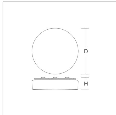
Dekorative runde Anbauleuchte. Armatur Metall pulverbeschichtet. Diffusor aus vergilbungsfreiem Kunststoff (PMMA) opal. Befestigung des Diffusors mit patentierter Verschlussstechnik (Druckverschluss). Geeignet für Deckenanbau, Wandanbau.
