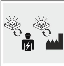
Die Lichtquelle dieser Leuchte darf nur vom Hersteller oder einem von ihm beauftragten Servicetechniker oder einer vergleichbar qualifizierten Person ersetzt werden. DIN EN 60598-1 / IEC 60598-1
