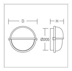
Applique robuste pour l'extérieur. Armature et couvercle en aluminium injecté traité époxy époxy. Avec valve à membrane pour réduire la condensation. Diffuseur en matière synthétique (polycarbonate) opalin. Étrier de fixation en inox avec compensation de la tolérance des trous de perçage. Raccordement secteur 2 x 3 x 1,5 mm².
