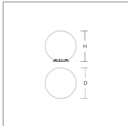
Luminaria decorativa para exterior. Soporte base de material sintético. Difusor esférico de material sintético (polietileno), opalino satinado mate. Soporte base con pies y adaptador separado para anclar la luminaria o la piqueta en el suelo. Con línea de conexión de 5 m con enchufe de seguridad, IP44. Solicitar por separado la lámpara RGB y accesorios para el montaje en el suelo.
