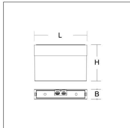
Luminaire pour marquage de voies de secours avec batterie autonome intégrée Corps matière synthétique (polycarbonate), résistant aux chocs. Plaque display en matière synthétique haute transparence avec pictogramme de secours simple/double face. 4 feuilles de pictogrammes de secours et 1 feuille blanche avec des épingles de fixation à insérer fournies. Équerre de fixation pour le montage mural et deux vis d'étanchéité également fournies. Système de batterie autonome avec auto-test automatique.
