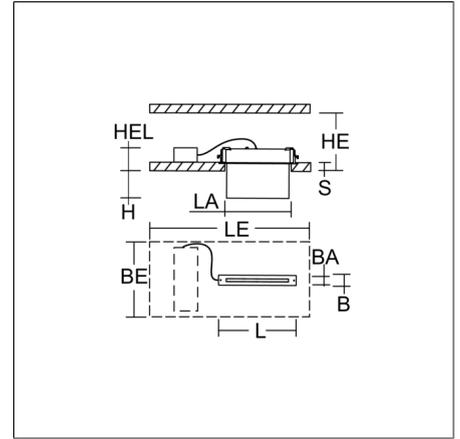
Leuchte zur Rettungswegkennzeichnung. Einbaugehäuse Stahlblech. Deckenplatte Edelstahl glänzend oder pulverbeschichtet. Displayscheibe Kunststoff hochtransparent mit Rettungszeichen einseitig/zweiseitig. Betriebsgeräte integriert. Einzelbatteriesystem mit automatischem Selbsttest und Rückmeldung an das RZB Überwachungssystem MULTIDIGIT. Symbolnummer für Rettungszeichen bei Bestellung angeben!
