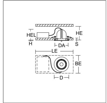
LED-Einbaustrahler zur Beleuchtung hervorzuhebender Stellen. Gehäuse Aluminium-Druckguss pulverbeschichtet. 356° dreh- und 90° aus-
