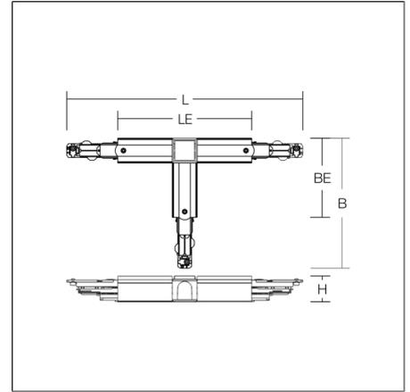
T-Kupplung, Kunststoff. Mit integrierter zusätzlicher 2-poliger-DALI-Leitung. Versorgungsleitung 16 A / 400 V. Steuerleitung DALI 2x 1 A / 50 V FELV AC.
