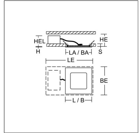
Superflaches Einbau-Downlight. Gehäuse Aluminium-Druckguss. Lightguide und Diffusor aus vergilbungsfreiem PMMA opal matt. Tunable White dynamisch einstellbar von 2700 K bis 6500 K. Deckenbefestigung mit Federsystem. Einbautiefe abhängig von Deckenstärke. Anbaugehäuse als Zubehör für alle Größen. Nachträglich montierbare Dekorzylinder aus Chintz-Stoff als Zubehör, optional mit Abdeckscheibe Kunststoff satiniert. Durchgangsverdrahtungsbox (5-polig) als Zubehör erhältlich.
