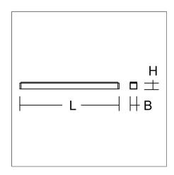
Decken- und Wandleuchte im minimalistischen Design. Gehäuse Aluminium-Strangpressprofil pulverbeschichtet. Endkappen Aluminium pulverbeschichtet. Diffusor aus vergilbungsfreiem Kunststoff (PMMA) opal. Geeignet für Deckenanbau, Wandanbau. Betriebsgerät extern mit Verbindungsleitung.
