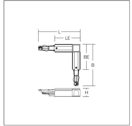
Acoplamiento angular 90° de material sintético. Línea adicional DALI de 2 polos integrada. Línea de alimentación de 16A / 400V. Línea de control DALI 2x1A / 50V / FELV AC.
