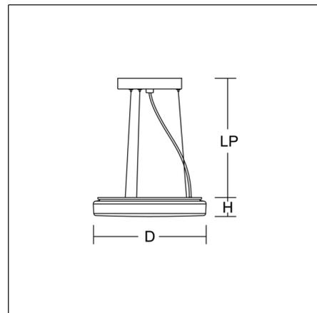
Luminaire suspendu LED rond décoratif. Armature et cache-piton en métal, traité époxy blanc. Cache-piton Ø 205 mm, h 35 mm. Diffuseur en plastique anti-jaunissement (PMMA) opalin. Fixation du diffuseur par technique de fermeture brevetée (fermeture à pression). Éclairage homogène et doux. Convient à suspension. Suspension par câble en 3 points réglable en hauteur en continu ou longueurs spéciales souhaitées sur demande.
