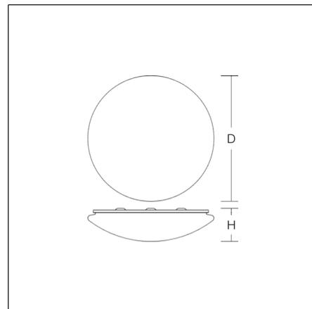
Luminaire apparent rond décoratif. Armature en métal traité époxy. Diffuseur en matière synthétique (polycarbonate) opalin, résistant aux chocs. Fixation du diffuseur par technique de fermeture brevetée (fermeture à pression). Convient à Montage des plafonniers, Flèche murale.
