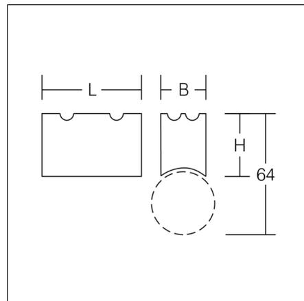
ISO-Fassung für Linienlampen. Einzelfassung Kunststoff. Ohne Zugentlastung für Anschlussleitung.
