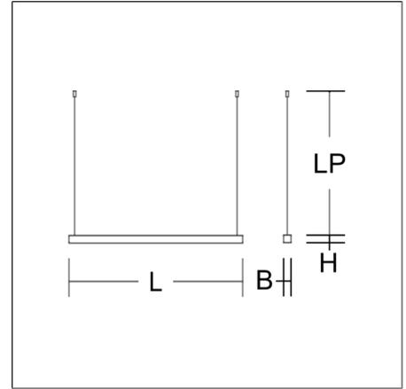
Pendelleuchte in minimalistischem Design. Gehäuse Aluminium-Strangpressprofil pulverbeschichtet. Endkappen Aluminium pulverbeschichtet. Diffusor aus vergilbungsfreiem Kunststoff (PMMA) mikroprismatisch. Lichtaustritt direkt 60%, indirekt 40%. Geeignet für Pendel. 2-Punkt Stahlseilabhängung stufenlos höhenverstellbar oder gewünschte Sonderlängen auf Anfrage. Betriebsgerät extern mit Verbindungsleitung.
