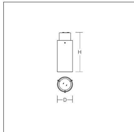
Dekorative runde Anbauleuchte. Armatur Aluminium pulverbeschichtet. Mundgeblasenes Drei-Schicht-Opalglas (Triplex-Glas) seidenmatt. Glasbefestigung mit Halteschrauben. Das Triplex-Glas sorgt für besonders homogenes, weiches und blendfreies Licht.
