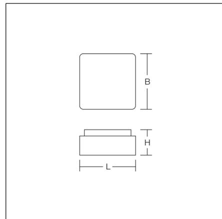
Flache quadratische Anbauleuchte. Armatur Kunststoff. Mundgeblasenes Opalglas seidenmatt. Glasbefestigung mit Federsystem. IP 43 Deckenmontage, IP 44 Wandmontage.
