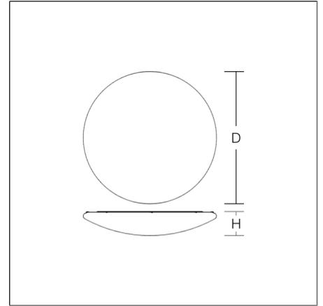
Decorativa luminaria redonda de montaje en superficie. Para iluminación de emergencia. Base de metal revestido al polvo. Difusor de material sintético opalino (PMMA) que no amarillea. Sujeción del difusor con mecanismo de cierre patentado (cierre a presión). Apto para Montaje en superficie de techos, Montaje en superficie de la pared. Sistema de emergencia autónoma con autotest y respuesta al sistema RZB de control MULTIDIGIT.
