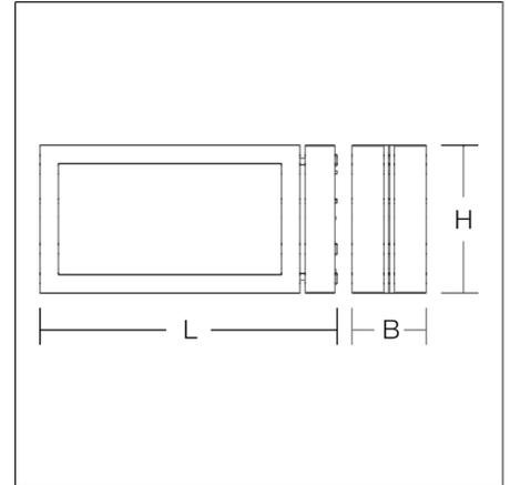
Luminaire pour la signalisation des voies d'évacuation. Corps en aluminium anodisé argent. Plaque display et technique de microlentille brevetée avec pictogramme de secours sur les deux faces. Etrier de fixation murale pour montage frontal Appareillage intégré. Système de batterie autonome avec auto-test automatique et retour d'information par bus DALI exclusivement au système de RZB surveillance DALI. Merci d'indiquer le numéro de motif du pictogramme de secours lors de la commande
