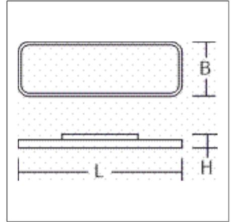
Dekorative rechteckige LED Anbau-Flächenleuchte. Flacher nahtloser Rahmen Aluminium-Strangpressprofil pulverbeschichtet. Abdeckung Stahlblech pulverbeschichtet. Diffusor aus vergilbungsfreiem Kunststoff (PMMA) mikroprismatisch. LED Backlight-Technologie für eine homogene Ausleuchtung der gesamten lichtabgebenden Fläche. Geeignet für Deckenanbau, Wandanbau. Einfachste Installation durch Plug & Play Stecksystem. Betriebsgerät integriert. DALI dimmbar. Für Durchgangsverdrahtung geeignet.
