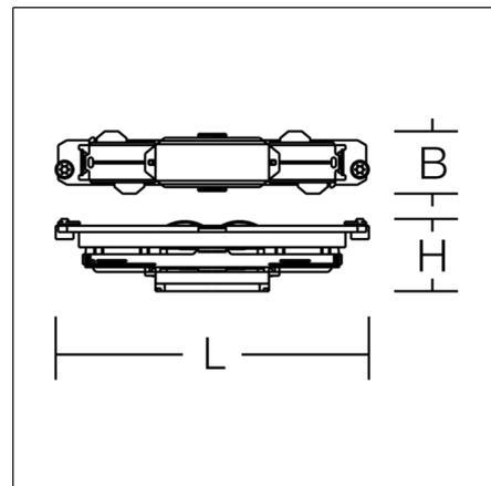
Jonction droite sans espace en matière synthétique, avec câble DALI 2 pôles supplémentaire intégré, câble d'alimentation 16 A / 400 V, ligne pilote DALI 2 x 1 A / 50 V FELV AC.
