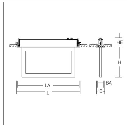
Leuchte zur Rettungswegkennzeichnung. Gehäuse Aluminium silberfarbig eloxiert. Displayscheibe mit patentierter MicroLens-Technik und Rettungszeichen einseitig. Betriebsgeräte integriert. Einzelbatteriesystem mit automatischem Selbsttest. Symbolnummer für Rettungszeichen bei Bestellung angeben!
