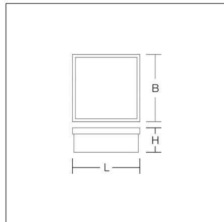
Luminaire apparent carré au design classique. Armature en matière synthétique. Diffuseur en matière synthétique (polypropylène) opalin mat satiné. Fixation du diffuseur par système de ressorts. Convient à Montage des plafonniers, Flèche murale. IP 43 montage au plafond, IP 44 montage mural.
