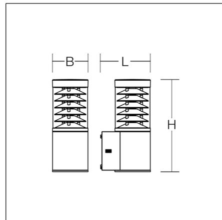
Dekorative Wandleuchte mit innovativem Gehäusekonzept und hochwertiger LED-Optik. Gehäuse aus korrosionsbeständigem Aluminium-Druckguss, seewasserbeständig pulverbeschichtet. Serienmäßig mit Membranventil zur Kondenswasser vermeiden. Abdeckung aus pulverbeschichtetem Aluminium-Druckguss mit klarem Glaszylinder und transluzenten Entblendlamellen. Wandbefestigung außerhalb des gedichteten Bereiches mit Bohrungstoleranzausgleich. Schraubenlose Leuchtenbefestigung mittels RZB Gravalock® System.
