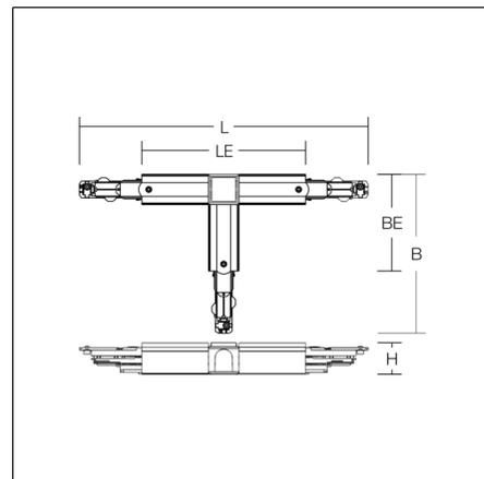
Jonction en T en matière synthétique, avec câble DALI 2 pôles supplémentaire intégré, câble d'alimentation 16 A / 400 V, ligne pilote DALI 2 x 1 A / 50 V FELV AC.
