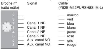
Remarque: Si le circuit auxiliaire n'est pas installé ou n'est pas utilisé, couper et mettre au rebut les conducteurs jaunes / verts ou gris / rouges.
