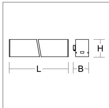
Luminaire mural linéaire. Boîtier en profilé d'aluminium extrudé, traité époxy. Embouts en aluminium traité époxy. Diffuseur en plastique anti-jaunissement (PMMA) opalin. Éclairage direct. Convient à Flèche murale. Unité LED extractible et interchangeable avec driver intégré. Convient pour le câblage traversant. Avec technologie de capteurs sur demande ou comme luminaire de secours.
