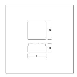
Quadratische Anbauleuchte im klassischen Design. Armatur Kunststoff. Mundgeblasenes Opalglas seidenglanz. Glasbefestigung mit Federsystem. Geeignet für Deckenanbau, Wandanbau. IP 43 Deckenmontage, IP 44 Wandmontage.
