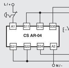
Configuración de las entradas con arranque manual 2 canales
