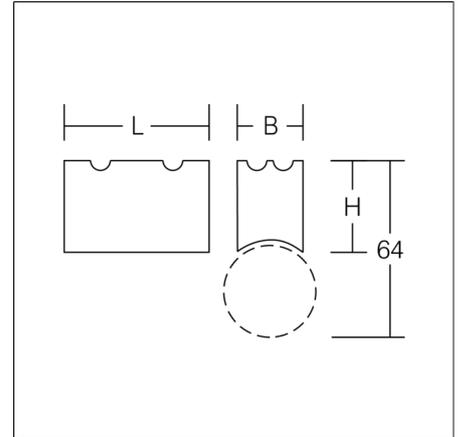
ISO-Fassung für Linienlampen. Einzelfassung Kunststoff. Ohne Zugentlastung für Anschlussleitung.
