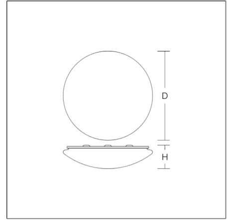
Decorativa luminaria redonda de montaje en superficie. Para iluminación de emergencia. Base de metal revestido al polvo. Difusor de material sintético opalino (PMMA) que no amarillea. Sujeción del difusor con mecanismo de cierre patentado (cierre a presión). Apto para Montaje en superficie de techos, Montaje en superficie de la pared. Equipo incluido.
