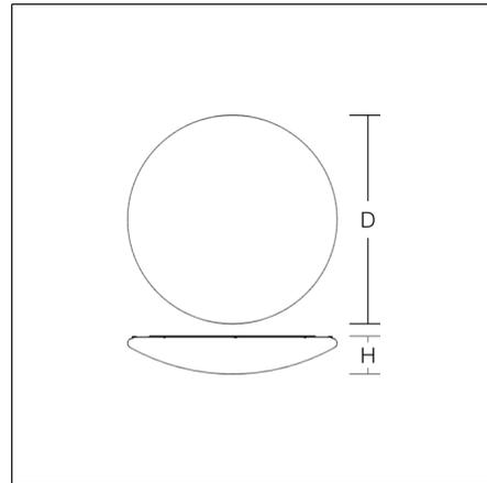
Decorativa luminaria redonda de montaje en superficie. Para iluminación de emergencia. Base de metal revestido al polvo. Difusor de material sintético opalino (PMMA) que no amarillea. Sujeción del difusor con mecanismo de cierre patentado (cierre a presión). Apto para Montaje en superficie de techos, Montaje en superficie de la pared. Sistema de emergencia autónoma con autotest y respuesta a través del bus DALI, exclusivamente al sistema RZB de control DALI.
