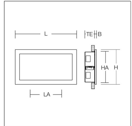
Luminaire pour la signalisation des voies d'évacuation. Corps en aluminium anodisé argent. Plaque display et technique de microlentille brevetée avec pictogramme de secours sur une face. Appareillage intégré. Système de batterie autonome avec auto-test automatique et retour d'informations au système de surveillance RZB MULTIDIGIT. Merci d'indiquer le numéro de motif du pictogramme de secours lors de la commande
