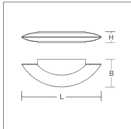
Un luminaire de forme unique avec verre elliptique. Armature en aluminium injecté laqué. Verre opaline soufflé à la bouche mat satiné avec caches d'extrémité transparents. Éclairage homogène et doux. Fixation du corps de luminaire avec des vis noyées. Montage horizontal et vertical possibles.
