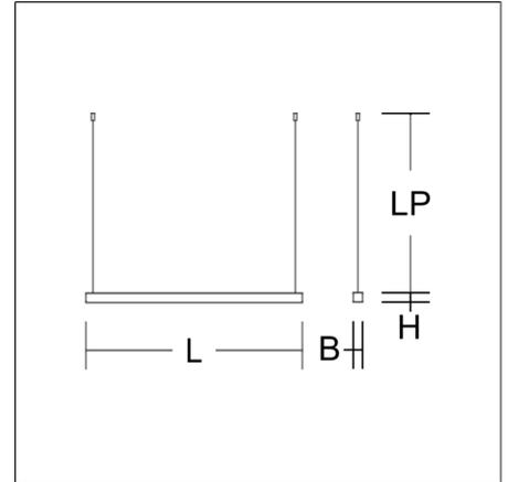
Pendelleuchte in minimalistischem Design. Gehäuse Aluminium-Strangpressprofil pulverbeschichtet. Endkappen Aluminium pulverbeschichtet. Diffusor aus vergilbungsfreiem Kunststoff (PMMA) opal. Lichtaustritt direkt 60%, indirekt 40%. Geeignet für Pendel. 2-Punkt Stahlseilab-
