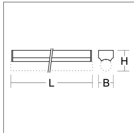
Réglette ISO pour lampes tubes linolites. Armature en matière synthétique. Avec interrupteur à poussoir. Coupure de courant aux douilles lors du changement des lampes. Lampes à commander séparément.
