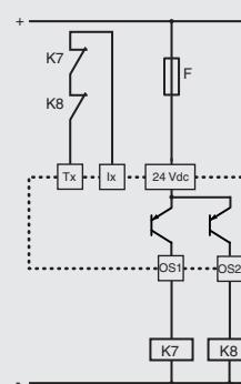
Circuito de retorno para contactores externos con arranque manual o controlado
