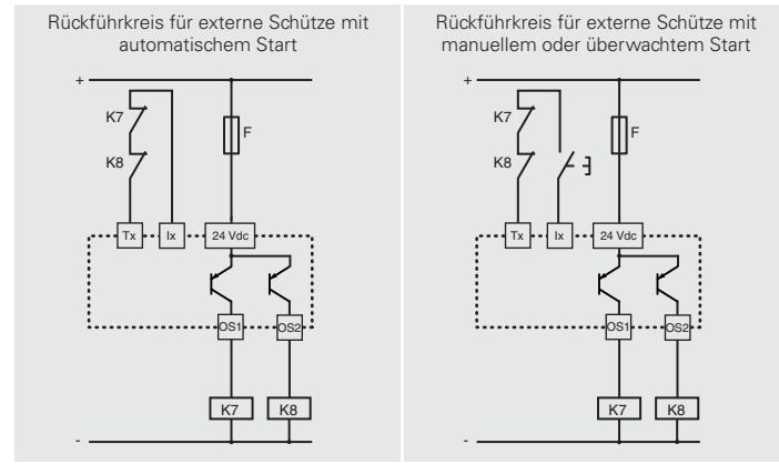
Für den ordnungsgemäßen Betrieb müssen Module oder eine SPS, die möglicherweise an die elektronischen OSx Sicherheits-Ausgänge angeschlossen sind, zyklische Deaktivierungstests tolerieren, die an den Sicherheits-Ausgängen durchgeführt werden.
