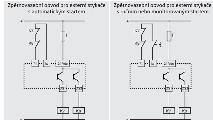
Aby správně fungovaly, musí všechny moduly nebo PLC připojené k bezpečnostním elektronickým výstupům OSx odolat cyklickým deaktivacím testům prováděným na modulech nebo PLC.
