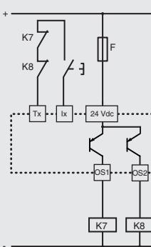
Para un funcionamiento correcto, cuando hay módulos o PLC conectados a las salidas de seguridad electrónicas OSx, estos deben tolerar los tests cíclicos de desactivación que se llevan a cabo en ellos.
