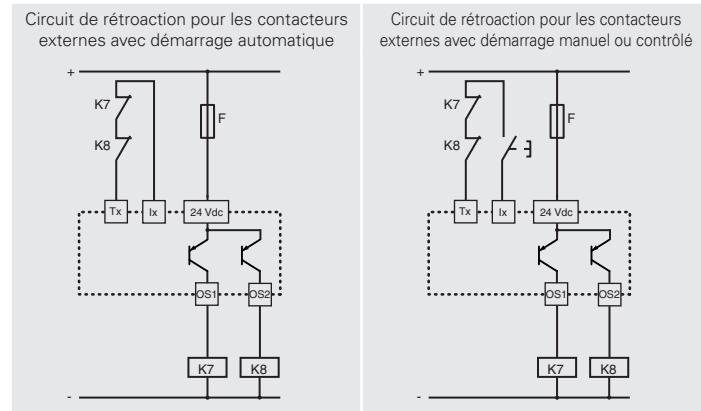
Pour un fonctionnement correct, tout module ou automate connecté aux sorties électroniques de sécurité OSx doit tolérer les tests cycliques de désactivation qui y sont effectués.
