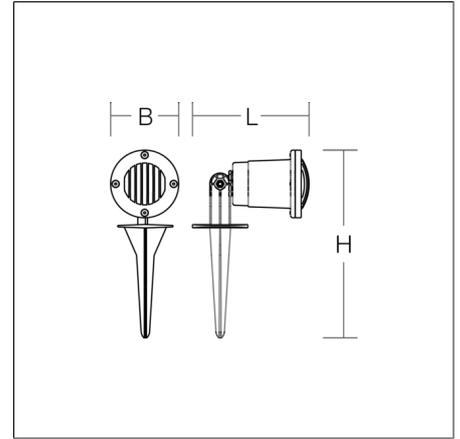
Projecteurs de jardin avec piquet pour le sol et grille de protection. Corps et cache en lamelles en aluminium injecté traité époxy. Verre de sécurité clair. Piquet en matière synthétique renforcé à la fibre. Module LED tension secteur interchangeable. Avec câble d'alimentation 3 m et fiche Schuko incluse.
