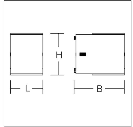
Wallscaping: Elegante und innovative Wandleuchte zur Akzentbeleuchtung. Gehäuse aus korrosionsbeständigem Aluminium-Druckguss, see-wasserbeständig pulverbeschichtet. Serienmäßig mit Membranventil zur Kondenswasser-Vermeidung. Abdeckung aus keramisch beschichtetem ESG mit Bajonettverschluss. Lichtaustritt nach oben und unten, Superspot/Wide flood. Wandbefestigung außerhalb des gedichteten Bereiches mit Bohrungstoleranzausgleich. Schraubenlose Leuchtenbefestigung mittels RZB Gravolock® System.
