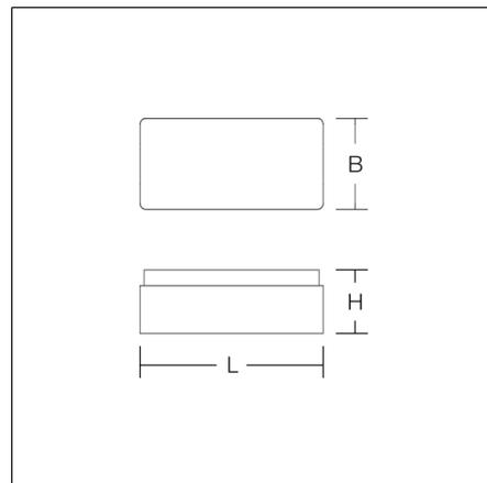
Rechteckige Anbauleuchte im klassischen Design. Armatur Kunststoff. Mundgeblasenes Opalglas seidenglanz. Glasbefestigung mit Federsystem. Geeignet für Deckenanbau, Wandanbau. IP 43 Deckenmontage, IP 44 Wandmontage.
