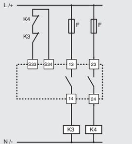
Circuito de retorno para contactores externos con arranque manual o controlado
