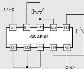
Konfigurace vstupu při ručním spuštění 2 kanály
