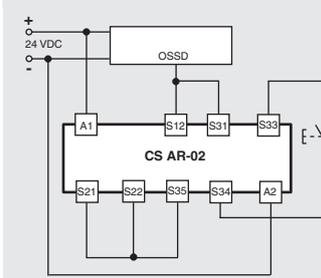
Configuración de las entradas con arranque manual 2 canales
