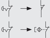
El módulo de seguridad puede supervisar circuitos de paro de emergencia, circuitos de control para resguardos móviles o sensores magnéticos de seguridad. Reemplace los contactos de los pulsadores de paros de emergencia con los contactos de los interruptores o de los sensores.
