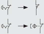
Das Sicherheits-Modul überwacht sowohl Not-Halt-Stromkreise, Stromkreise zur Kontrolle beweglicher Schutzvorrichtungen als auch magnetische Sicherheits-Sensoren. Dazu die Kontakte der Not-Halt-Taster durch die Kontakte der Schalter oder Sensoren ersetzen.
