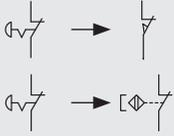
Le module de sécurité peut contrôler indifféremment des circuits d'arrêt d'urgence, des circuits de contrôle pour protecteurs mobiles ou des capteurs magnétiques de sécurité. Remplacer les contacts des arrêts par les contacts des interrupteurs ou des capteurs.
