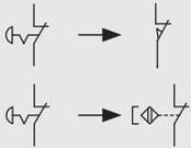
Bezpečnostní modul může monitorovat obvody nouzového zastavení, řídicí obvody pro pohyblivé kryty a magnetické bezpečnostní senzory. Vyměňte kontakty nouzového zastavení za spínací kontakty nebo kontakty snímače.
