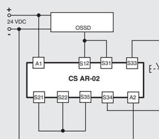
Konfigurace vstupu při ručním spuštění 2 kanály
